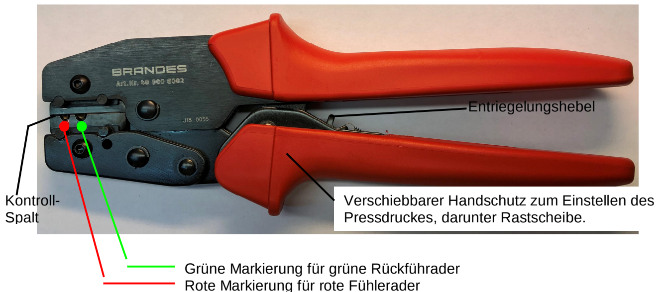
Abbildung 12.1 Quetschzange BS-QZ22
