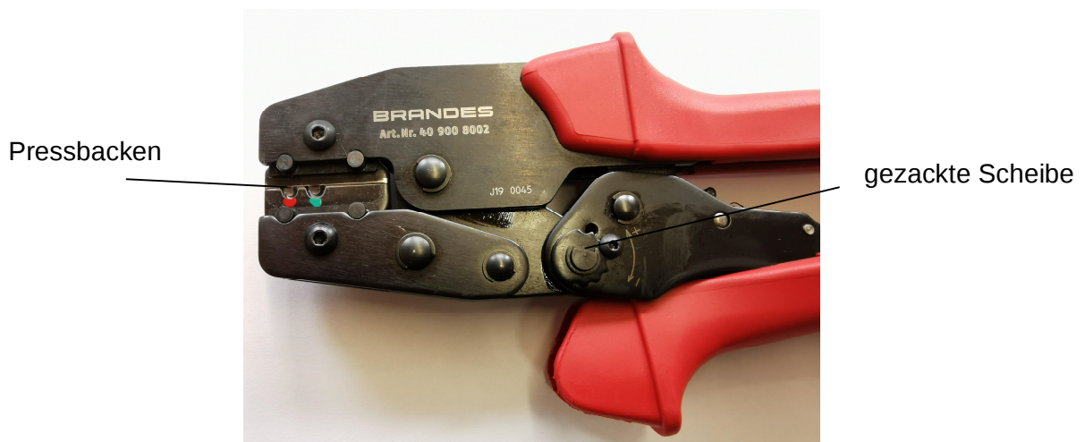
Abbildung 3.1 Geschlossene Quetschzange BS-QZ22 mit anliegenden Pressbacken
